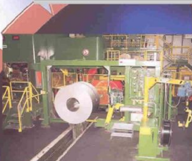
Увязка бухт нержавеющей стали на реверсивном стане холодного проката.
