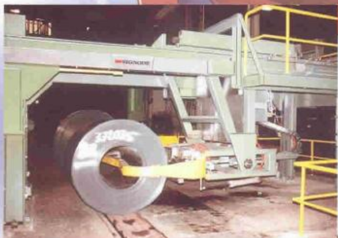
Строповка горячих бухт через проушину.
