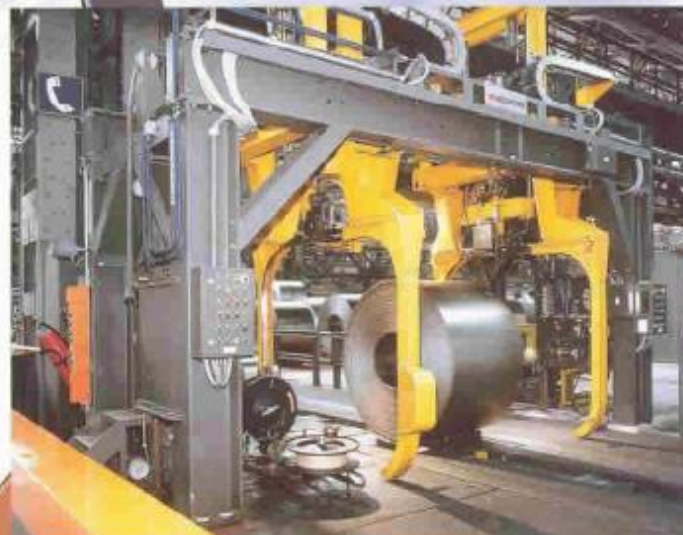
На заводе Skin-Pass бухты могут увязываться стальной либо полиэстеровой лентой для обеспечения максимальной гибкости.
