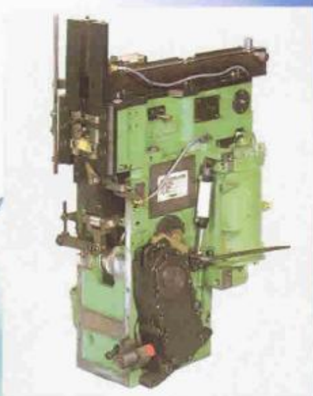
Универсальная модульная ленточная головка M-400 – отраслевой стандарт упаковки для металлургии.
