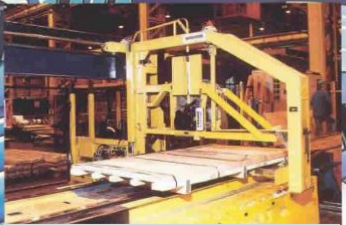
Листы нержавеющей стали, автоматически фиксируемые на деревянных поддонах.
