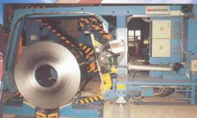
Многопозиционная увязка бухты гальванизированной стали с использованием головки M400 на движущей каретке.
