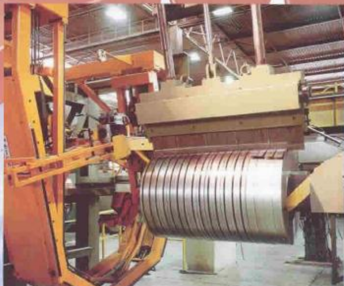
Автоматическая круговая увязка узких рулонов на кабестане.
