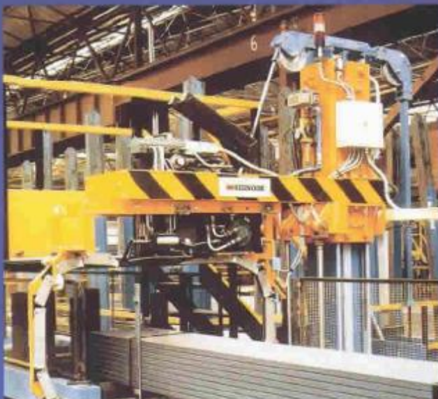
Полностью автоматизированная упаковка как шестигранных, так и квадратных связок труб.
